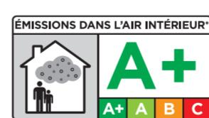
Information sur le niveau d'émission de substances volatiles dans l'air intérieur, présentant un risque de toxicité par inhalation, sur une échelle de classe allant de A+ (très faibles émissions) à C (fortes émissions).
