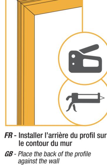
FR - Installer l'arrière du profil sur le contour du mur
