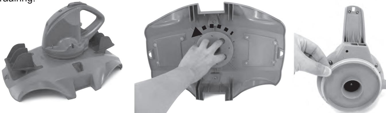
2. Draai de 4 schroeven op de onderkant van de draaikop los met de schroevendraaier om de onderste plaat eerst los te maken. Gebruik de schroevendraaier om alle schroeven op de basis los te schroeven zoals op de afbeelding. Verwijder de waaier en wrik dan de basis los en verwijder hem zodat u bij de kop kunt komen.
