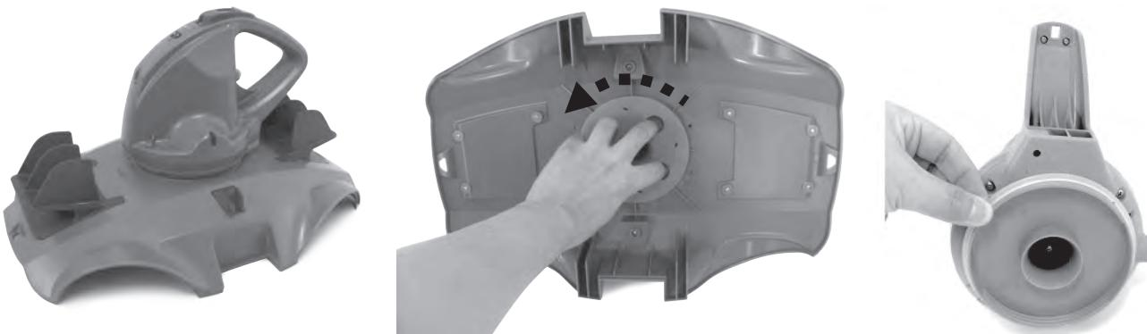
2. ΧΡΗΣΙΜΟΠΟΙΗΣΤΕ ΤΟ ΚΑΤΣΑΒΙΔΙ ΓΙΑ ΝΑ ΞΕΒΙΔΩΣΕΤΕ ΤΙΣ 4 ΒΙΔΕΣ ΠΟΥ ΒΡΙΣΚΟΝΤΑΙ ΣΤΟ ΚΑΤΩ ΜΕΡΟΣ ΤΗΣ ΚΕΦΑΛΗΣ ΩΣΤΕ ΝΑ ΑΠΕΛΕΥΘΕΡΩΣΕΤΕ ΠΡΩΤΑ ΤΗΝ ΠΛΑΚΑ ΤΗΣ ΒΑΣΗΣ. ΧΡΗΣΙΜΟΠΟΙΗΣΤΕ ΤΟ ΚΑΤΣΑΒΙΔΙ ΓΙΑ ΝΑ ΞΕΒΙΔΩΣΕΤΕ ΟΛΕΣ ΤΙΣ ΒΙΔΕΣ ΤΗΣ ΒΑΣΗΣ ΟΠΩΣ ΦΑΙΝΕΤΑΙ. ΑΦΑΙΡΕΣΤΕ ΤΗΝ ΦΤΕΡΩΤΗ ΚΑΙ ΣΤΗ ΣΥΝΕΧΕΙΑ ΞΕΒΙΔΩΣΤΕ ΤΗ ΒΑΣΗ ΚΑΙ ΑΦΑΙΡΕΣΤΕ ΤΗΝ ΩΣΤΕ ΝΑ ΑΠΟΚΑΛΥΦΘΕΙ Η ΚΕΦΑΛΗ ΠΟΥ ΕΙΝΑΙ ΜΕΣΑ.
