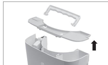
Smontare il serbatoio dell'acqua ai fini della pulitura e rimontarlo in ordine inverso prima di inserirlo nuovamente nel dispositivo.
