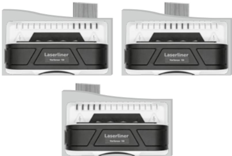
**Spänningsvarning:** Blixtsymbolerna lyser för att visa att det finns strömförande ledningar.
