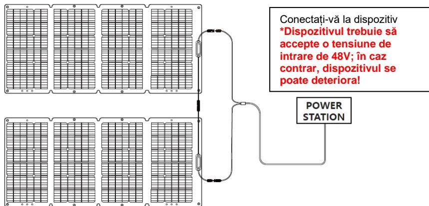
2. Înlăntuiți 3 panouri solare pentru a vă încărca dispozitivul.
