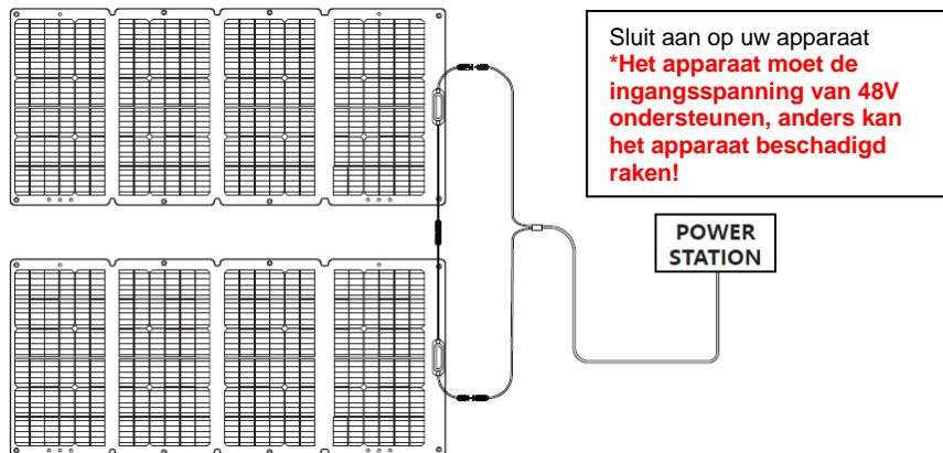
2. Schakel 3 zonnepanelen in serie om uw apparaat op te laden.
