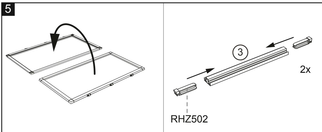
Draai het frame om en bevestig RHZ502 op beide kanten van profiel 3.
