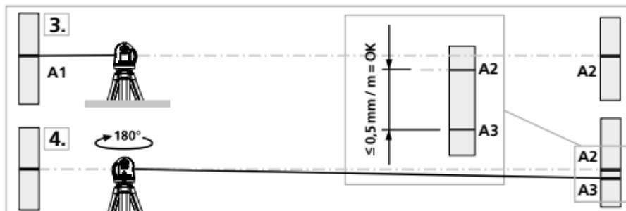
! Jos A2 ja A3 ovat toisistaan etäämmällä kuin  $0,5 \text{ mm} / \text{m}$ , on säätö tarpeen. Ota yhteys paikalliseen laitetoimittajaan tai UMAREX-LASERLINER huoltoosastoon.
