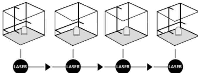
Para a nivelação horizontal e vertical é preciso que o bloqueador de transporte esteja solto. O LED acende constantemente com cor verde. Logo que o aparelho se encontre fora da área de nivelação automática de 5°, as linhas de laser piscam e o LED acende com cor vermelha. Posicione o aparelho de modo a que se encontre dentro da área de nivelação. O LED volta a mudar para verde e as linhas de laser acendem constantemente.
