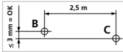
cerca de 2,5 m para a direita. Verifique se a linha horizontal do ponto C se encontra a uma altura  $\pm$  3 mm do ponto B. Repita o processo, mas agora girando a cruz do laser para a esquerda.
