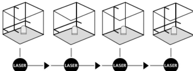
Horisontal og vertikal nivellering krever at transportsikringen løsnes. LED-en lyser konstant grønt. Straks apparatet befinner seg utenfor det automatiske nivelleringsområdet på  $5^\circ$ , blinker laserlinjene og LED-en lyser rødt. Posisjoner apparatet slik at det befinner seg innenfor nivelleringsområdet. LED-en lyser grønt igjen og laserlinjene lyser konstant.
