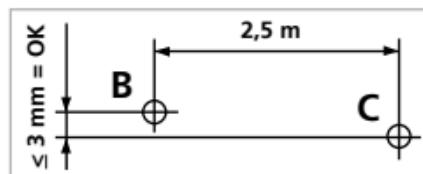
på väggen. Sväng laserkorset cirka 2,5 m åt höger och markera punkt C. Kontrollera om den vågräta linjen från punkt C ligger inom  $\pm 3$  mm i höjdled jämfört med punkt B. Upprepa proceduren vid svängning åt vänster.
