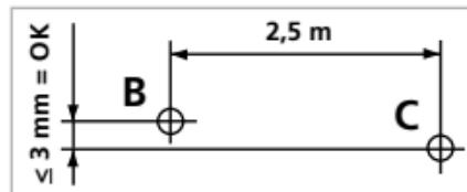
2,5 sağa kaydırıp, C noktasını işaretleyiniz. C noktasındaki yatay çizginin B noktasıyla  $\pm 3$  mm'lik bir aralıktaki aynı hızda bulunup bulunmadığın kontrol ediniz. Aynı işlemi bu sefer sola kaydırarak tekrar ediniz.
