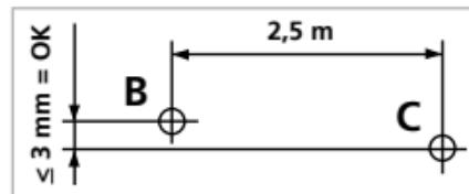
w prawo i zaznaczyć punkt C. Sprawdzić, czy punkty B i C leżą w poziomie (tolerancja  $\pm 3$  mm). Pomiar powtórzyć przesuwając laser w lewo.
