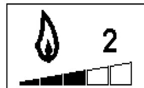
3.2.5 Appuyez sur les boutons « ← » et « → » afin de sélectionner l'un des trois réglages de flammes
