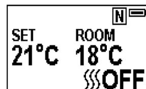
3.2.11 Appuyez sur les boutons « + » et « - » pour modifier les réglages de température. Il est préférable de choisir les températures de consigne suivantes : de 17°C à 25°C.
