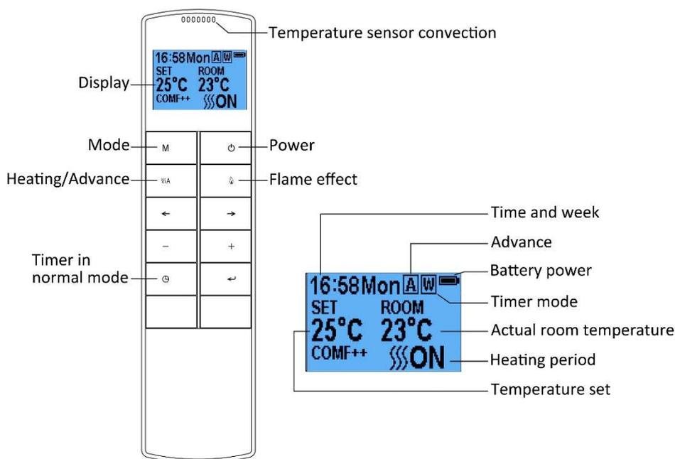
**Belangrijk!** Dit is een afstandsbediening met thermostaat. De afstandsbediening dient ten alle tijden in dezelfde ruimte te zijn als waar de haard zich bevindt en geplaatst worden op een vlakke ondergrond.
