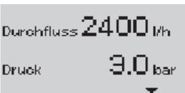
Schließen Sie die Absperrvorrichtungen der Druckleitung, sobald die Pumpe beginnt, kontinuierlich Wasser zu fördern. Im Display werden „**Durchfluss**“ und „**Druck**“ angezeigt.
