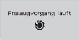
Der Ansaugvorgang kann bis zu 6 min. dauern. Wenn danach kein Wasser gefördert wird, schaltet der Haus- & Gartenautomat ab und im Display wird „**FEHLER 2**“ angezeigt (siehe 7. FEHLERBEHEBUNG).
