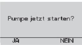
Drücken Sie die **linke Taste**
