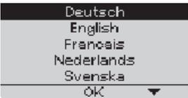
Wählen Sie mit der **linken** bzw. **rechten Taste** die gewünschte Display-Sprache und bestätigen Sie diese mit der **mittleren Taste**
