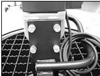
Schrauben Sie die Maschine mit den 4 beiliegenden Innensechskantschrauben M8x20 und den dazu gehörenden Sicherungsringen fest an die Rührstation an.
