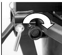
Steek de motorkop met de mengmand in de kuip en vergrendel het door de gekartelde schroef in de richting van het pijltje te draaien.
