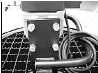
Bevestig het apparaat stevig op het standaard d.m.v. de 4 Allen schroeven M8 x 20 en de specifieke afdichtringen.
