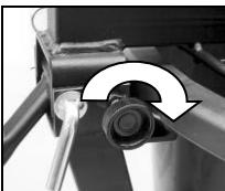
Klappen Sie den Motorkopf mit dem Rührquirl in den Mischkübel und schließen Sie die Verriegelung durch Drehen der Rändelschraube in Pfeilrichtung.
