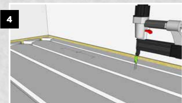
Niet het element vast met spreidnieten 35-40mm h.o.h. 200mm
