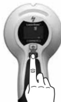
**!** O aparelho e a parede precisam de estar em contacto durante a calibragem (exceto na calibragem no ar), bem como durante todas as medições. Ao mesmo tempo, a mão deve ser mantida no aparelho.
