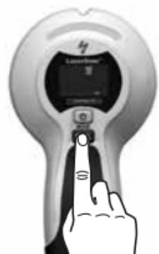
! Das Gerät und die Wand müssen bei der Kalibrierung (Ausnahme bei Kalibrierung in der Luft) sowie während der gesamten Messungen in Kontakt bleiben. Ebenso sollte die Hand am Gerät bleiben.
