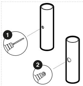
Percer un pré-trou de 8 mm (foret non fourni) qui servira de guide à la scie cloche et faire le trou de 42 mm (fourni).
