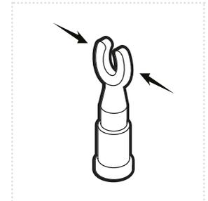
Après avoir lubrifié l'écope, la comprimer et l'introduire dans le conduit.
