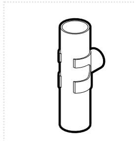
Présenter le collier du collecteur autour du conduit après en avoir sélectionné le diamètre. Serrer au moyen de 2 vis inox.
