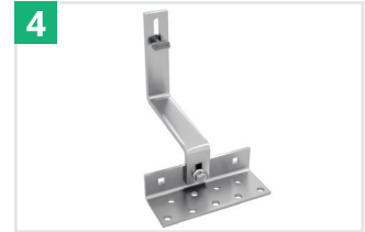
Dakhaak 2steel RVS, 3-voudig verstelbaar, 140 mm
