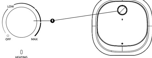
Draai de aan/uit knop om de boiler in te schakelen.
