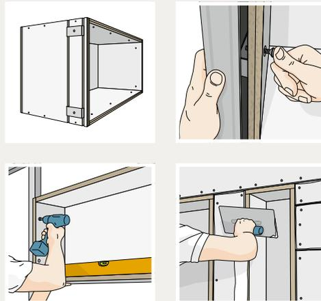
Die patentierte Befestigung mit der Klammer verbindet den Korpus stabil mit dem Knauf CW-dB-Profil. Eine Spachtelkante an den Frontkanten und die Imprägnierung der Bauteile verhindern langfristig eine Rissbildung. Ausreichende Materialhärte macht Kantenschutzprofile überflüssig. Das System sorgt somit für glatte und verzugsfreie Oberflächen – langlebig und hochwertig.
